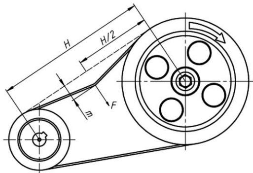
Контролировать величину натяжения необходимо с помощью динамометра в соответствии со схемой, приведённой выше, где,
