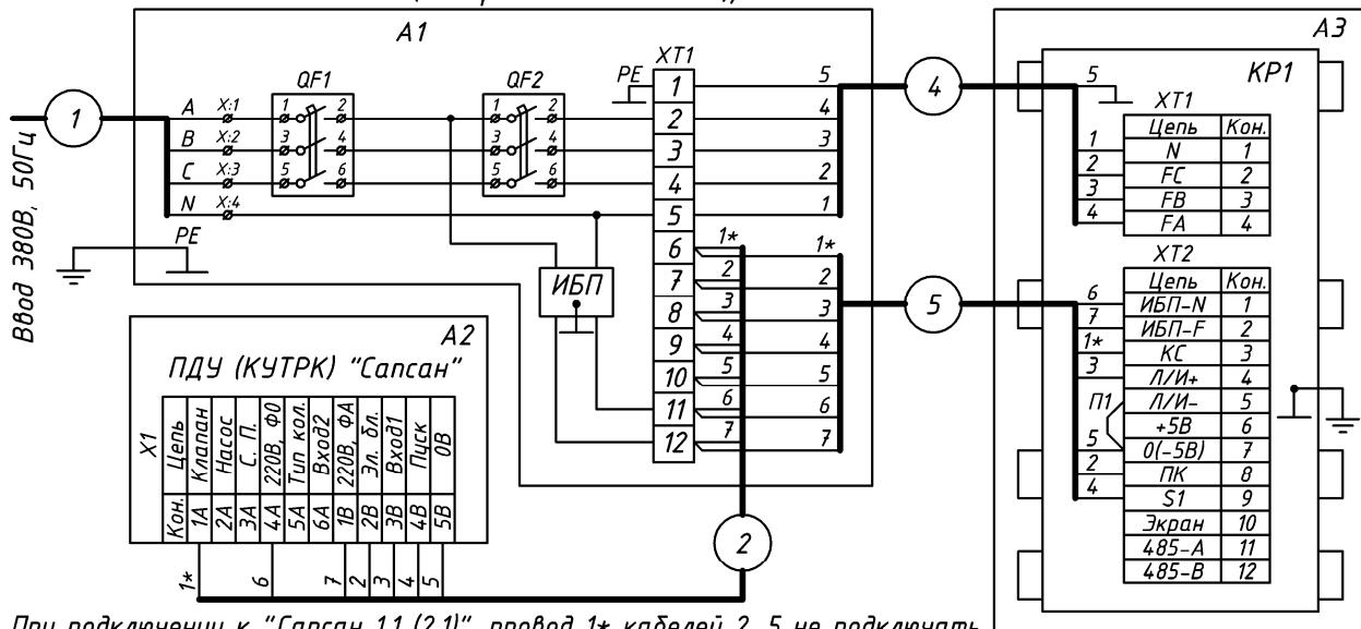
При подключении к "Сапсан 1.1 (2.1)", провод 1\* кабелей 2, 5 не подключать
