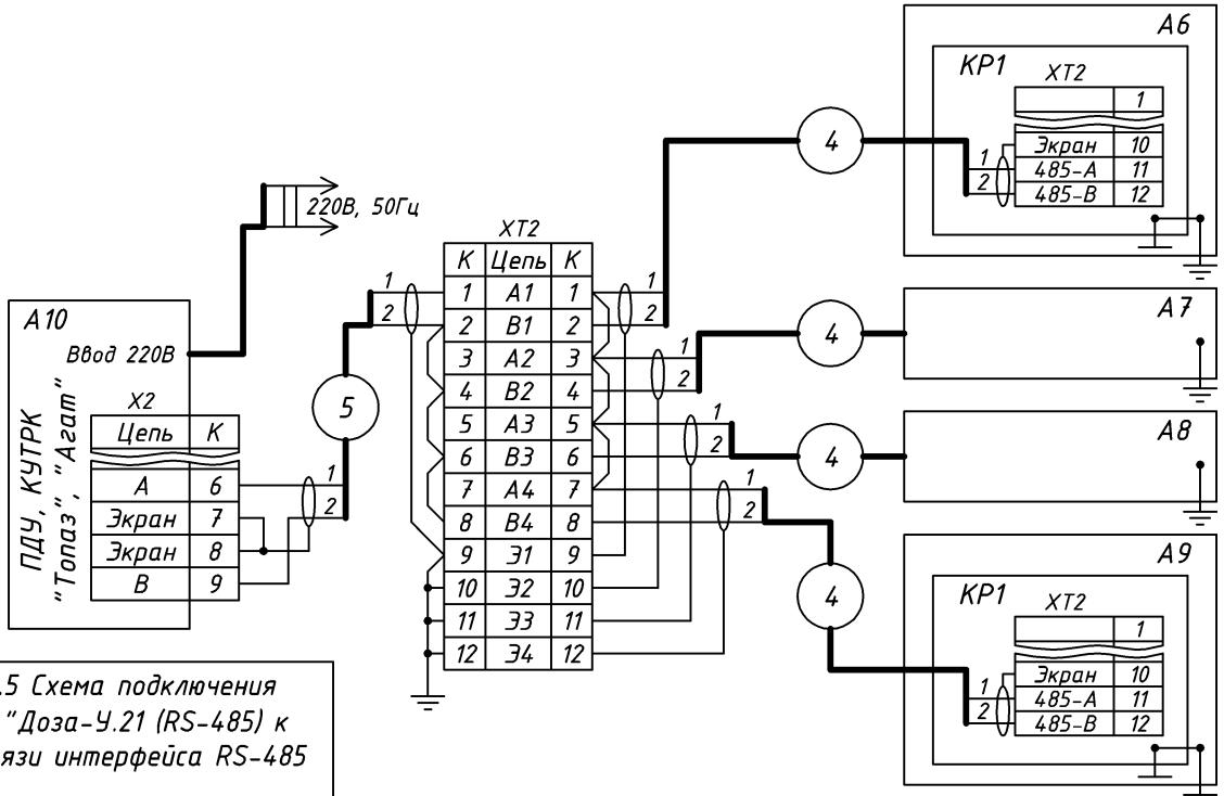
Рис. 5.5 Схема подключения КУТРК "Доза-У.21 (RS-485) к линии связи интерфейса RS-485
