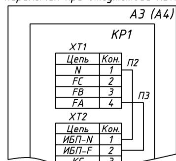
Рис. 4.1 Схема электрическая подключения ТРК "Квант-111" в ручном и местном режимах
