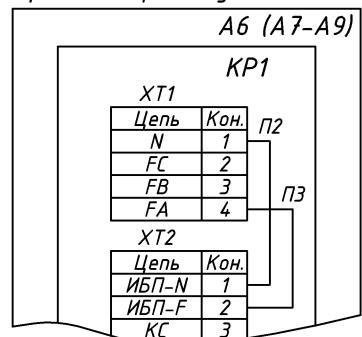
Рис. 5.3 Схема электрическая подключения линии связи ТРК "Квант-111" с топологией "звезда"
