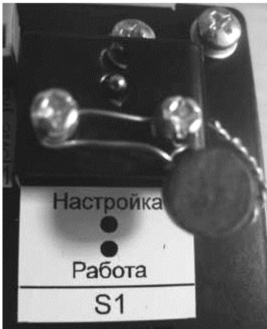
Рис.3. Пломбировка тумблера
