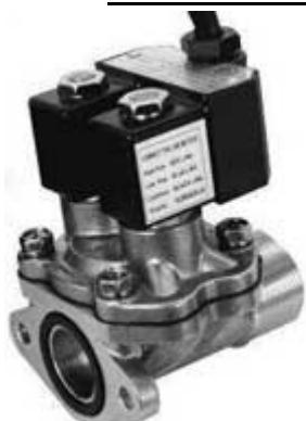
Клапан электромагнитный предназначен для управления потоком топлива, обеспечивая снижение расхода топлива перед окончанием выдачи дозы и прекращение подачи топлива после выдачи заданной дозы. Электромагнитный клапан имеет три состояния: закрыт, открыт на малый поток, открыт на большой поток. Управление состоянием клапана осуществляется путем подачи и снятия питающего напряжения. Управление клапаном обеспечивается электромагнитными катушками, которые при
