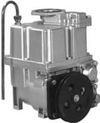
Моноблок представляет собой комплекс, в котором соединены функции насоса и газоотделителя. В верхней части моноблока располагается выход, к которому присоединяется измеритель объема.
