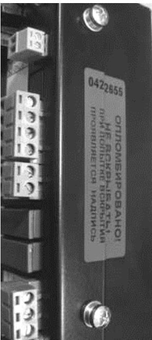
Рис.4. Пломбировка корпуса блока
