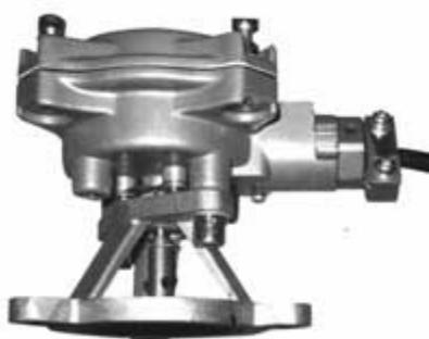
Датчик расхода топлива применяется для преобразования механического вращения вала измерителя объема в количество последовательных электрических импульсов, используя при этом оптический метод. Валу датчика расхода передается вращение от измерителя объема. На валу закреплен диск с прорезями, при вращении которого формируются два импульсных сигнала, со разницей по фазе 90°. Количество формируемых датчиком импульсов пропорционально объему выданного топлива.
