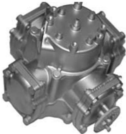
Измеритель объема предназначен для измерения количества жидкости, проходящего через ТРК в единицах объема. Он представляет собой четырехцилиндровый гидравлический двигатель приводимый в движение протекающим через него топливом.
